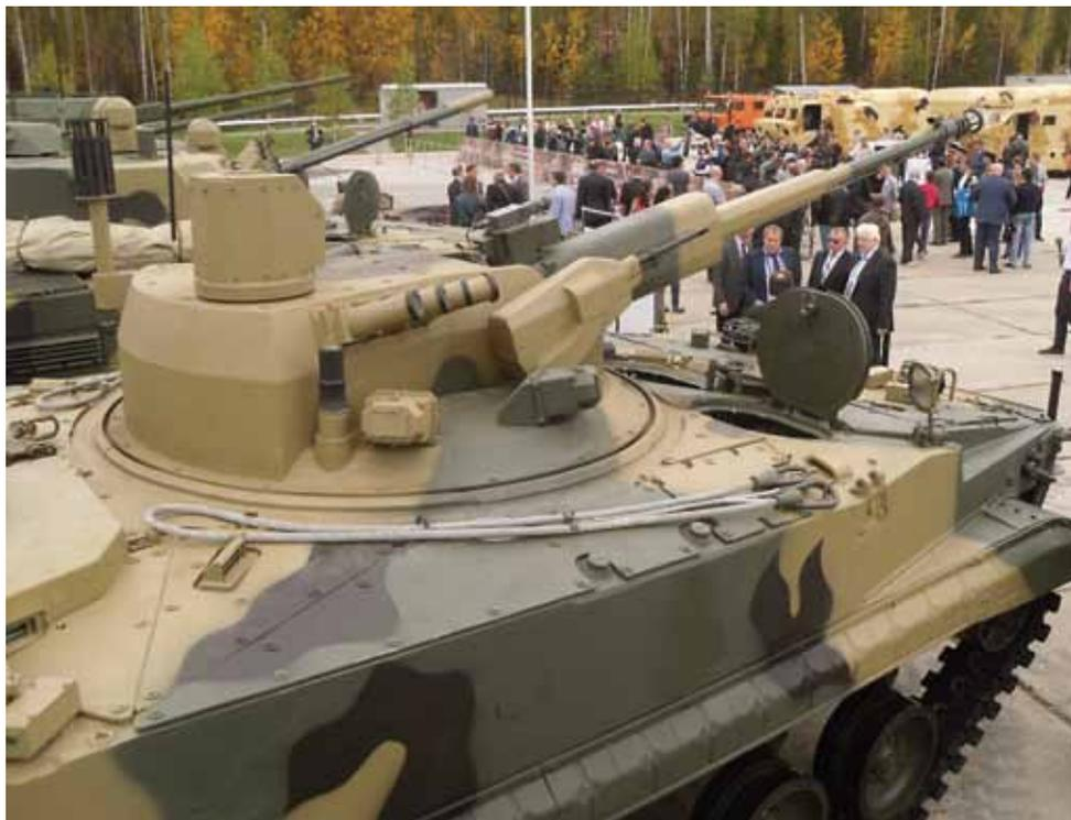
...и БМП-3 «Деривация» с дистанционно управляемым боевым модулем АУ-220М
