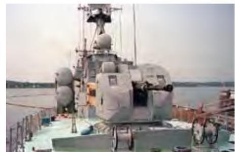
Скорострельная автоматическая корабельная артиллерийская установка АК-176, разработанная в ЦНИИ «Буревестник»
