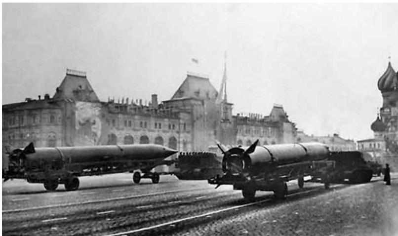
С 1951 года начались работы по ракете Р-5. По конструкции Р-5 являлась одноступенчатой ракетой с несущими баками с системой уменьшения невыработанных остатков топлива и отделяемой головной частью.
