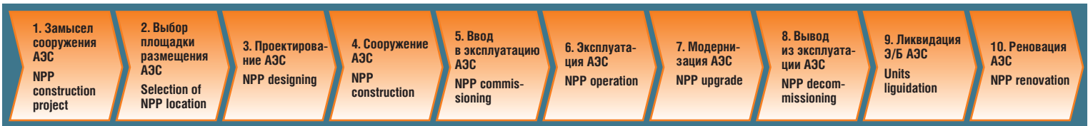
Рис. 1 – Стадии жизненного цикла АЭС / Figure 1 – NPP Lifecycle Stage
