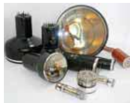
Фотоэлектронный умножитель ФЭУ производства ОАО «ЭКРАН», г. Новосибирск
