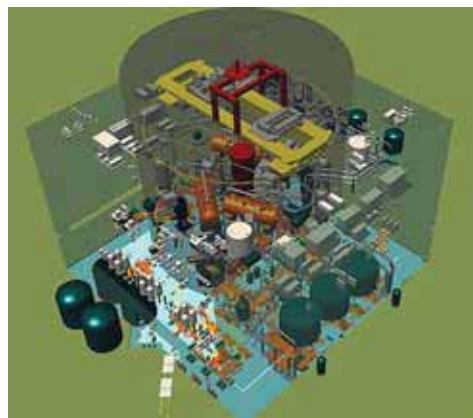
Рис. 2. Трехмерная модель реакторного отделения АЭС Figure 2. A 3D model of NPP reactor unit
