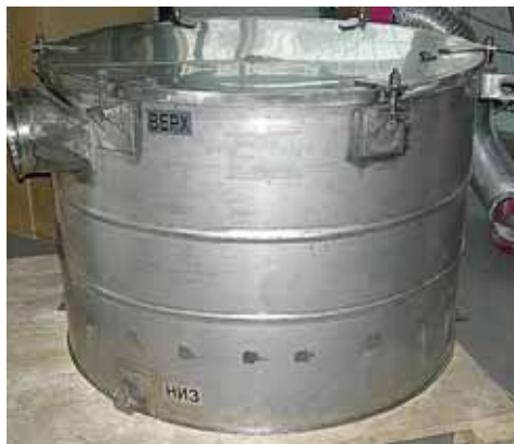
Фильтр-адсорбер АУИ со сменным сорбирующим картриджем
