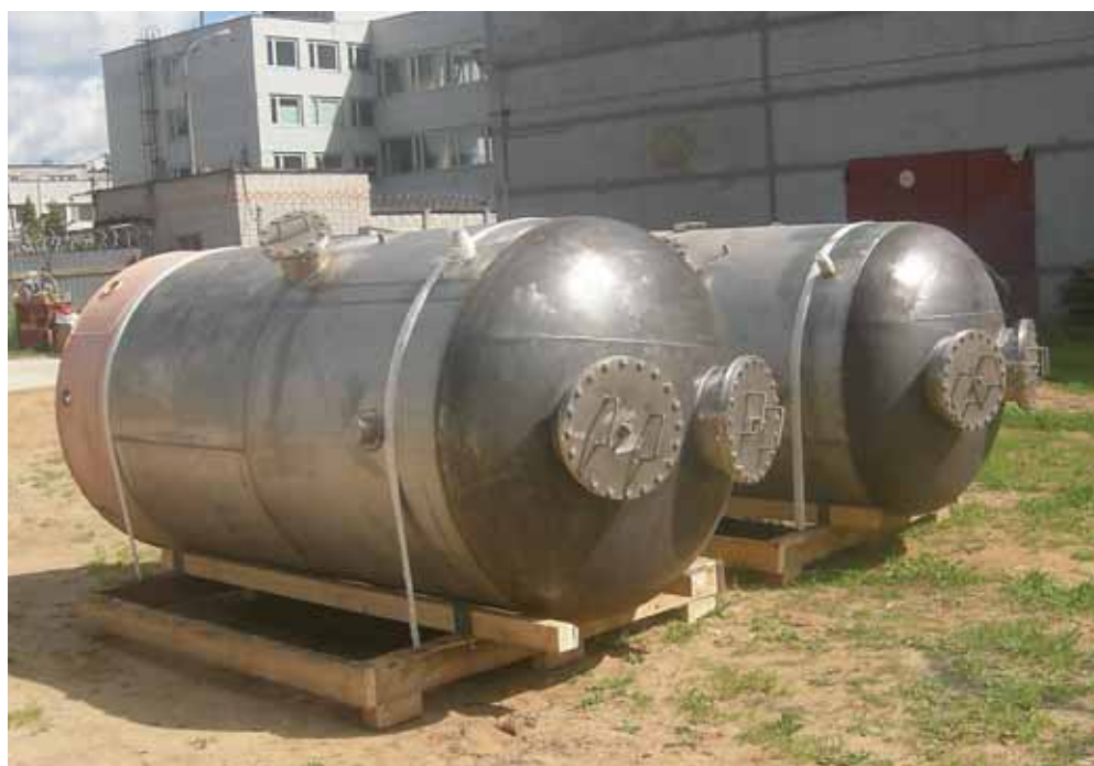
Фильтры-адсорберы ФАУ-65 с угольной насадкой для очистки технологических выбросов АЭС
