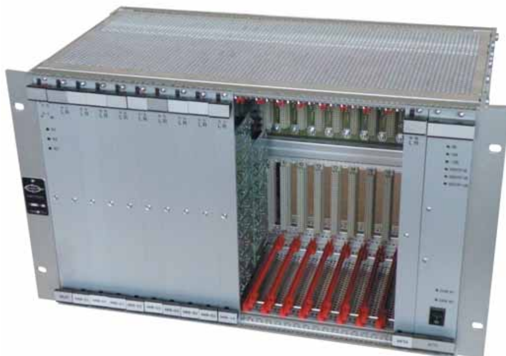
Контроллер с централизованной архитектурой
