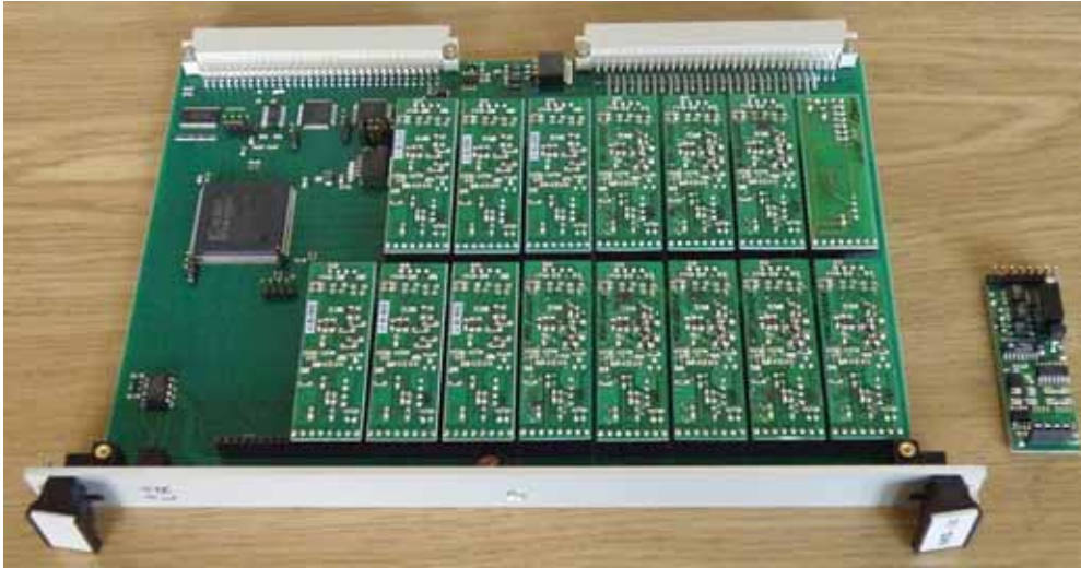
Модуль функциональный (МФ) с установленными мезонинами
