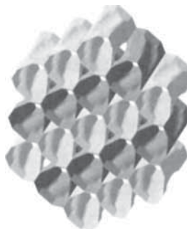
Рис. 1. Внешний вид 19-ячеистого фрагмента сотовой дистанционирующей перемешивающей решетки Fig. 1. General view of the 19-rod cellulose section of the spacer mixing grid
