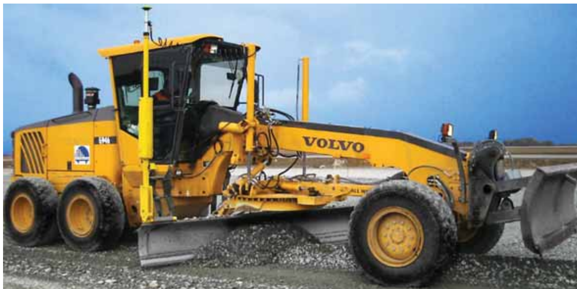
Строительная техника с установленным оборудованием автоматизированного нивелирования
