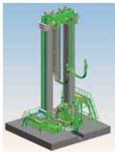
Рис. 5. Проект печи электрошлакового переплава
