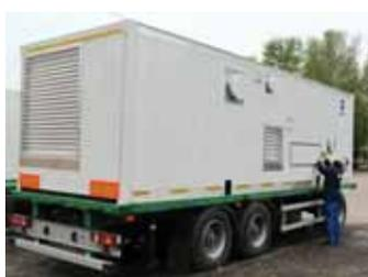
**Автономная насосная установка, производительность 1200 м<sup>3</sup>/час, напор 10 кгс/см<sup>2</sup> / A standalone pumping facility with discharge of 1,200 м<sup>3</sup>/h and head flow of 10 kgf/cm<sup>2</sup>**
