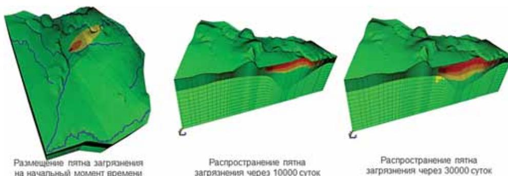
Рис. 14. Расчет последствий аварии на Балтийской АЭС / Fig. 14. Computation of accident consequences at Baltiyskaya NPP
