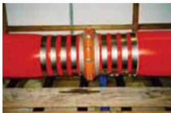
**Плосковорачиваемый рукав Ø300 мм с быстроразъемным соединением / A lay-flat hose 300 mm with fast-acting couplings**
