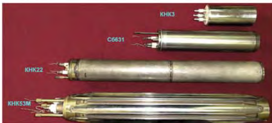
Рис. 1. Токовые камеры для регистрации нейтронов с компенсацией гамма-фона с твердым борным радиатором / Pic. 1. Current chambers used to register neutrons and compensate gamma background with a solid boron radiator
