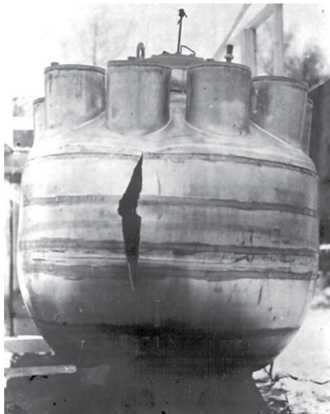
Модель корпуса реактора БН-800 после взрыва
