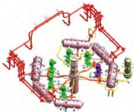
Рис. 6. 3D-модель «Первый контур ВВЭР-440»
