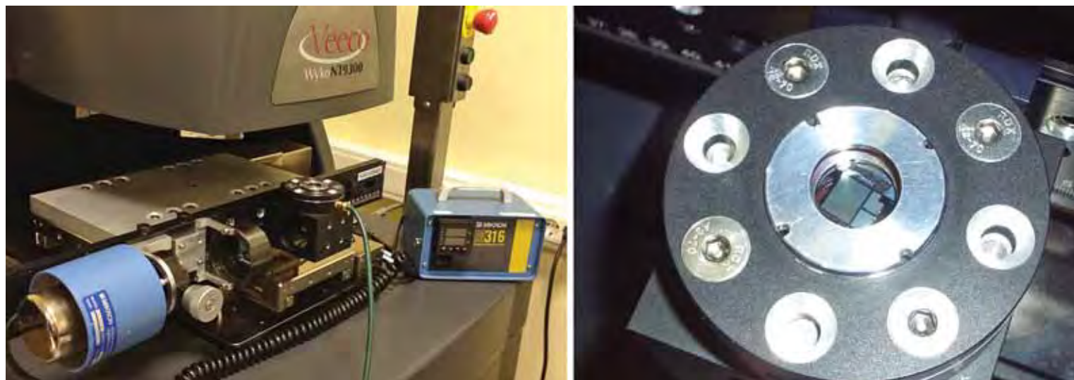
Рис. 5. Фотография стенда и вакуумная камера с размещенной в ней матрицей тепловых сенсоров на МЭМС Pic. 5. Photo of a stand and a vacuum chamber containing a matrix of MEMS thermal sensors (to the left)
