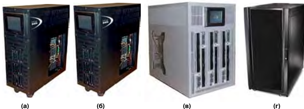
Рис. 2. Ряд АПК разработки РФЯЦ-ВНИИЭФ, основу которых составляют КС-ЭВМ различной производительности: (а) АПК-1М (1 ТФлопс); (б) АПК-2М (1 ТФлопс); (в) АПК-3 (3 ТФлопс); (г) АПК-5 (5 ТФлопс) Fig. 2. A number of HSC developed by RFNC-VNIIEF, based on compact supercomputers of various performance characteristics: (a) APK-1M (1 Teraflop); (b) APK-2M (1 Teraflop); (c) APK-3 (3 Teraflops); (d) APK-5 (5 Teraflops)
