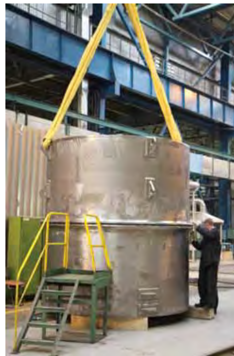
Сборка корпуса ЗДК / Guard vessel assembly
