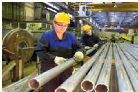
Контроль технологических труб из алюминиевых сплавов типа САВ / Inspection of aluminum-base alloy pipes
