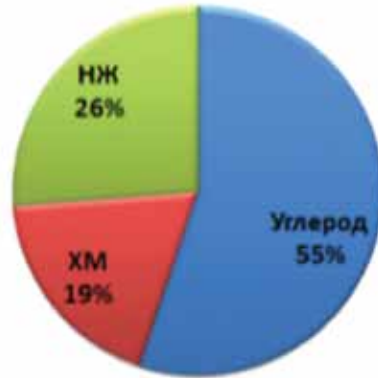
Соотношение материалов трубопроводов, применяемое для турбоустановки по технологии ARABELLE
