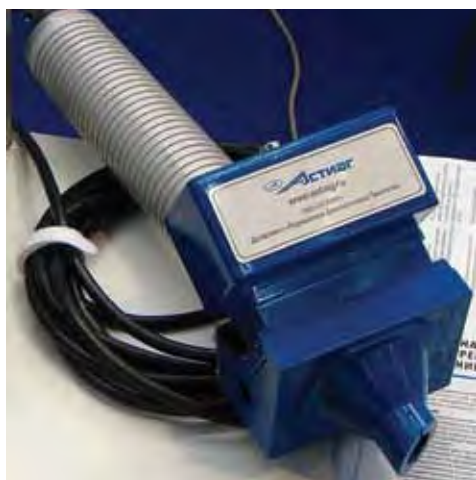
Рис. 3. Установка для измерения механических напряжений
