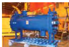
Рис. 3. Сварные кожухопластинчатые теплообменники
