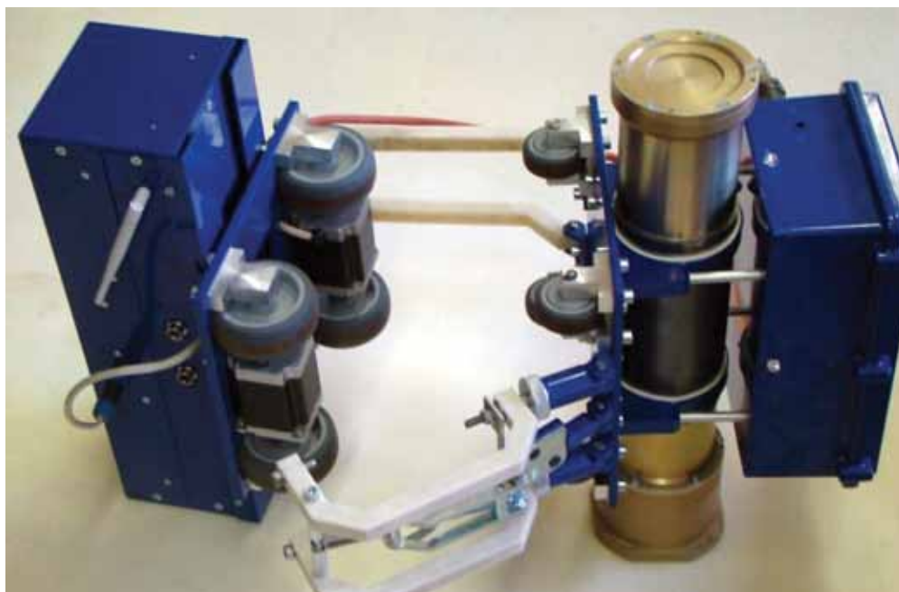
Рис. 1. Общий вид установки для просвета швов трубопроводов
