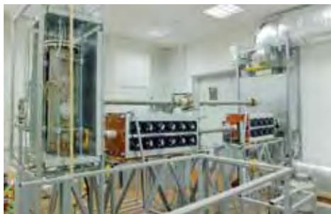
теплопереноса при свободноконвективных течениях натрия в цилиндрических сосудах. В результате работы для двух каналов, имеющих разные аспектные соотношения, и для разных углов наклона оси каналов к горизонту получены зависимости характеристик теплообмена, теплопереноса и турбулентности от внешних параметров.
