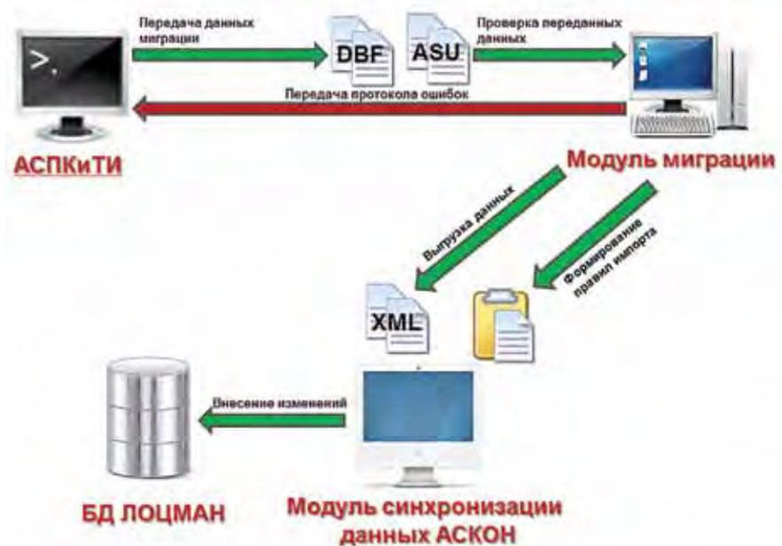
Рис 3. Архитектура процесса миграции в PDM-систему
