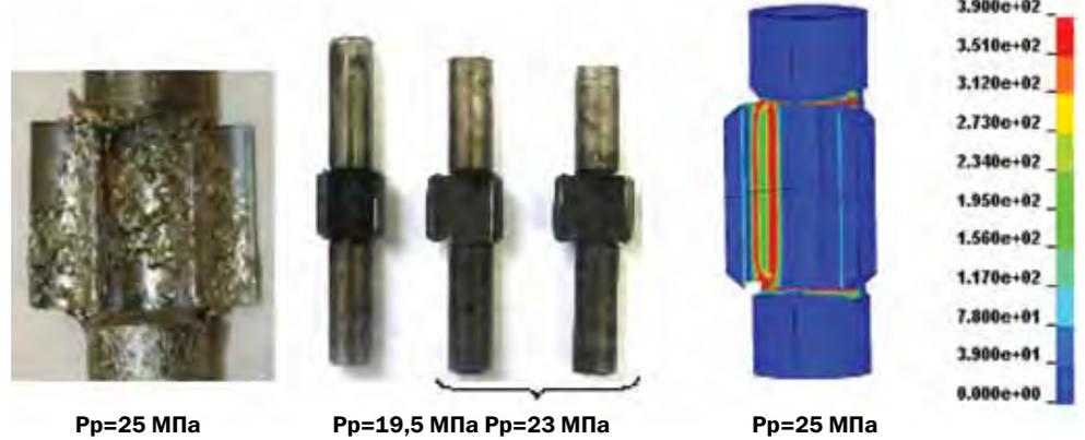
**Рис. 4. Раскрытие дефекта в свинце и на воздухе. Эксперимент и расчет,  $t=500^\circ\text{C}$**
