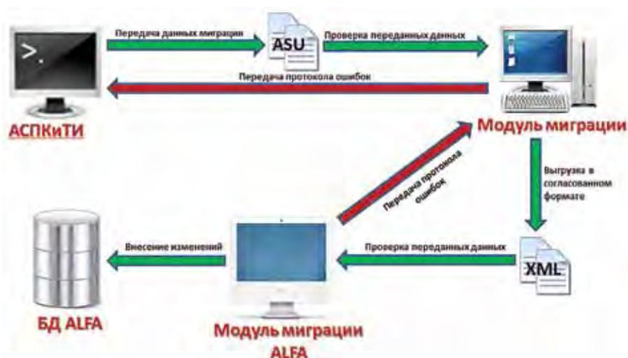
**Рис. 1. Архитектура процесса миграции в MES-систему**
