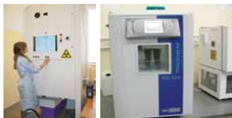
Рис. 1. Камера «тепло-холод-влага» ТСС 4010 (справа), рентгеновский комплект «FILIN-122/160» (слева)
