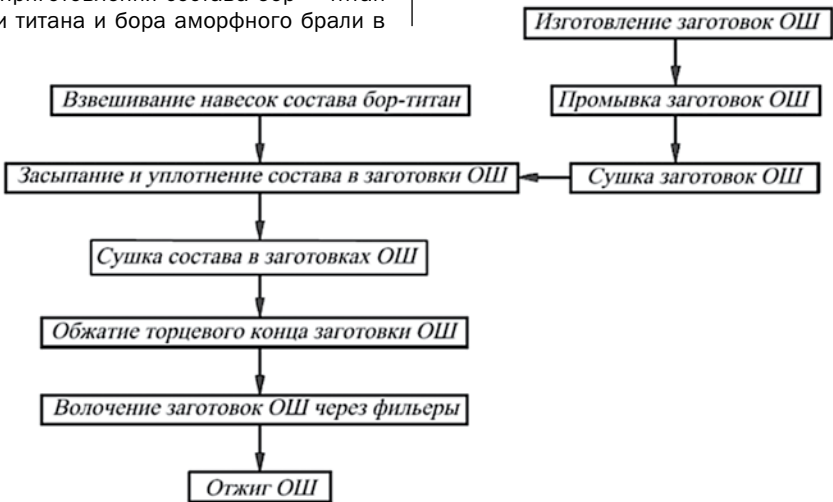
Рис. 2. Технологическая схема изготовления ОШ
