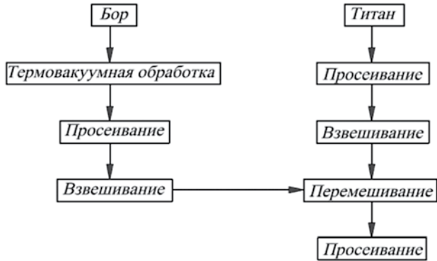
Рис. 1. Технологическая схема приготовления состава бор-титан
