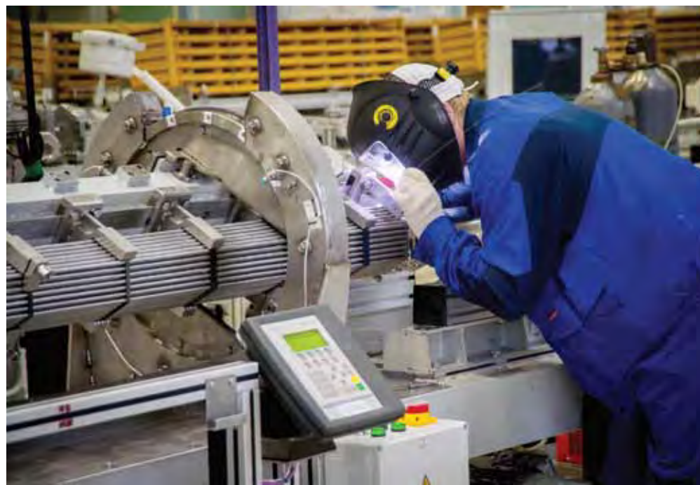
Стенд сборки пучка с хвостовиков
