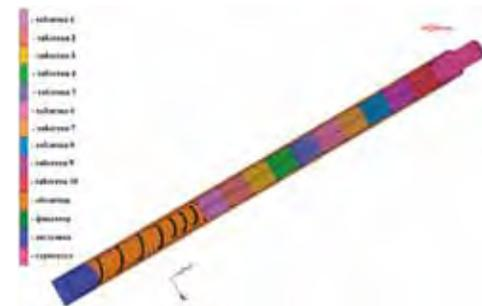
**Сборная конструкция ТВЭЛа, модель для расчёта в Marc**
