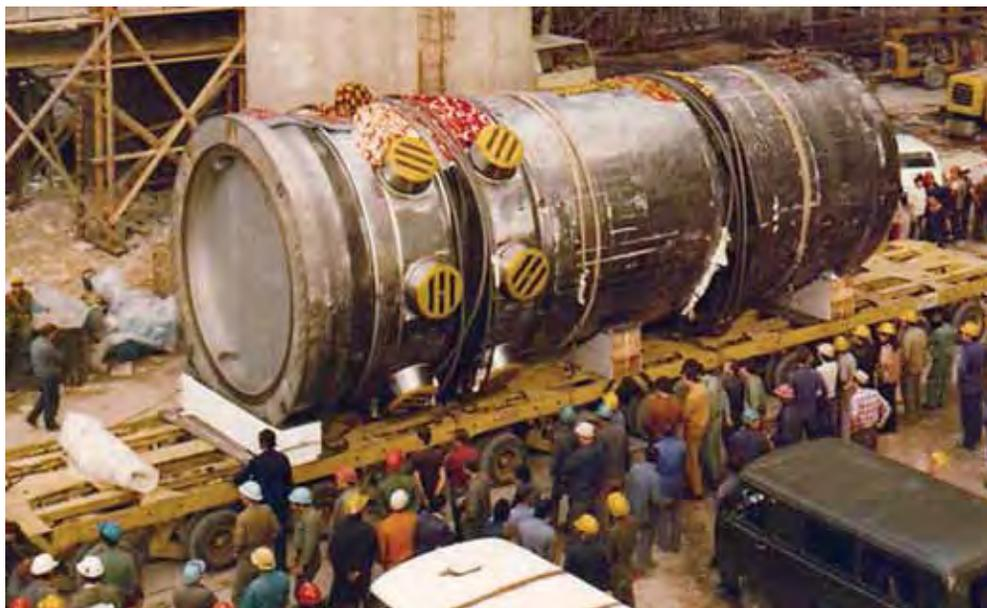
Корпус ядерного реактора
