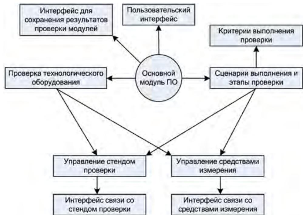
Рис. 2. Структура программного обеспечения стенда проверки
