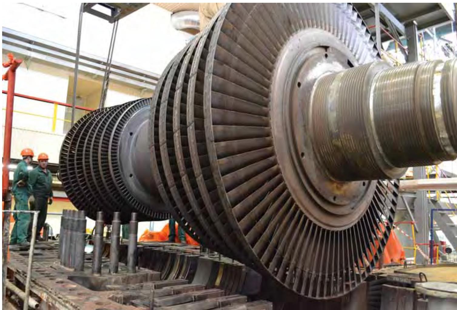
Процесс демонтажа ротора из ЦВСД
