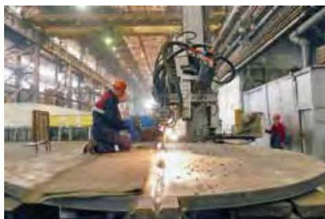
Автоматическая сварка листа для днища емкости для АЭС «Куданкулам»
