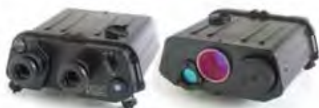
Лазерный безопасный дальномер EG-LRF (ЛДИ-11)
