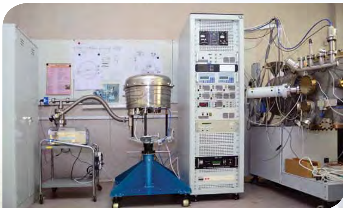
Опытный образец установки для реализации технологии МЛЭ в космосе и стенд-имитатор космического вакуума (справа)
