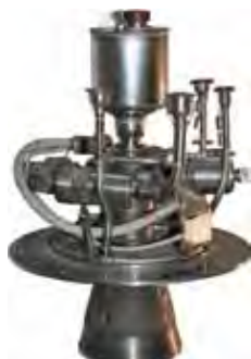
Первый экологически безопасный двигатель малой тяги 17Д16
