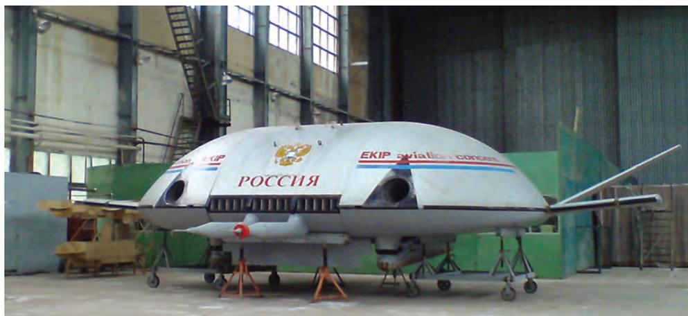
безотрывное обтекание аппарата воздухом на взлетно-посадочных и крейсерском режимах полета при углах атаки до 40 градусов. При помощи управляющих двигателей и УПС аппараты ЭКИП способны произвести «птичью посадку» по крутой глиссаде при снижении посадочной скорости до 100 км/ч.
