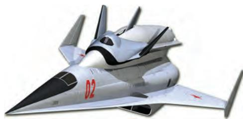
Воздушно-орбитальный самолет задумывался как авиационно-космическая система, состоящая из гиперзвукового самолета-разгонщика и боевого пилотируемого одноместного многоэтапного орбитального самолета с ракетным ускорителем
