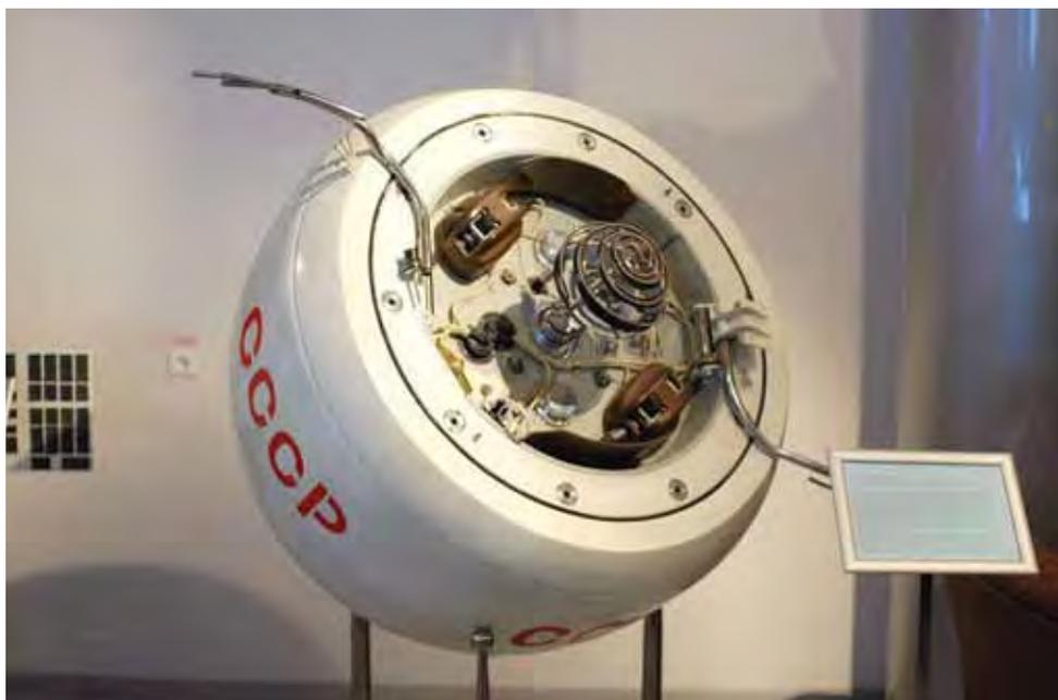
Спускаемый аппарат станции «Венера-7»
