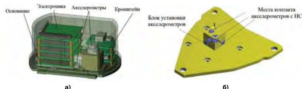
Рис. 1. а) Пример БА БИНС; б) Расчетная схема конструкции НС БА
