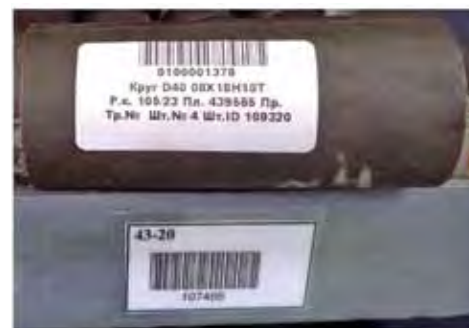
Рис. 2. Пример штрих-кодирования металла
