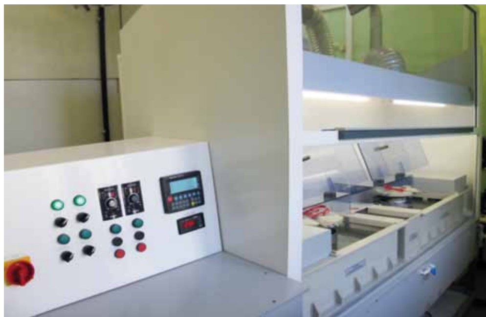
Рис. 2. Установка выращивания алюмооксидных слоев «Дельта-2/4. АНОКС-К»
