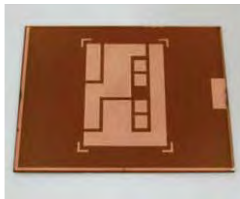
Рис. 4. Фоторезистивная защитная маска для гальванического меднения
