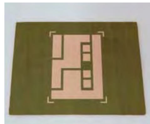
Рис. 6. Коммутационная плата на алюминиевом основании
