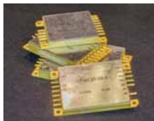
Источники питания разработки ЗАО «ГК «Электронинвест» с использованием микросхемы HEU1501
