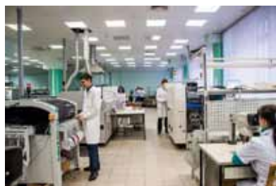
Участок монтажа печатных плат
