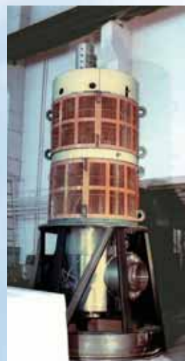
Электромагнитный насос ЦЛИН-3/3500 для второго контура реактора БН-350
