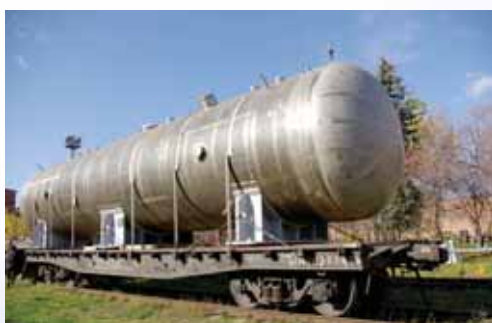
Сосуд для натрия для реактора БН-800 Белоярской АЭС
