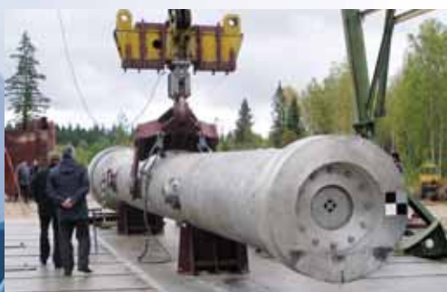
Испытания на полигоне ОКБМ транспортно-упаковочного контейнера
