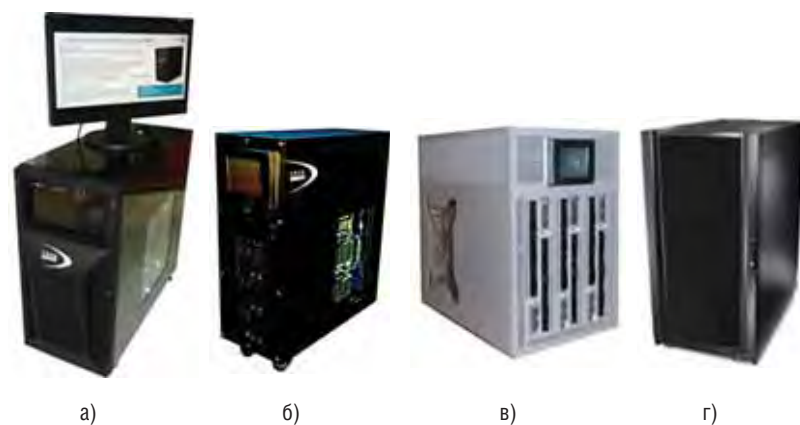
Рисунок 2. Базовый ряд компактных суперЭВМ разработки РФЯЦ-ВНИИЭФ: а) АПК-1 (1 ТФлопс); б) АПК-1М (1 ТФлопс); в) АПК-3 (3 ТФлопс); г) АПК-5 (5 ТФлопс)
