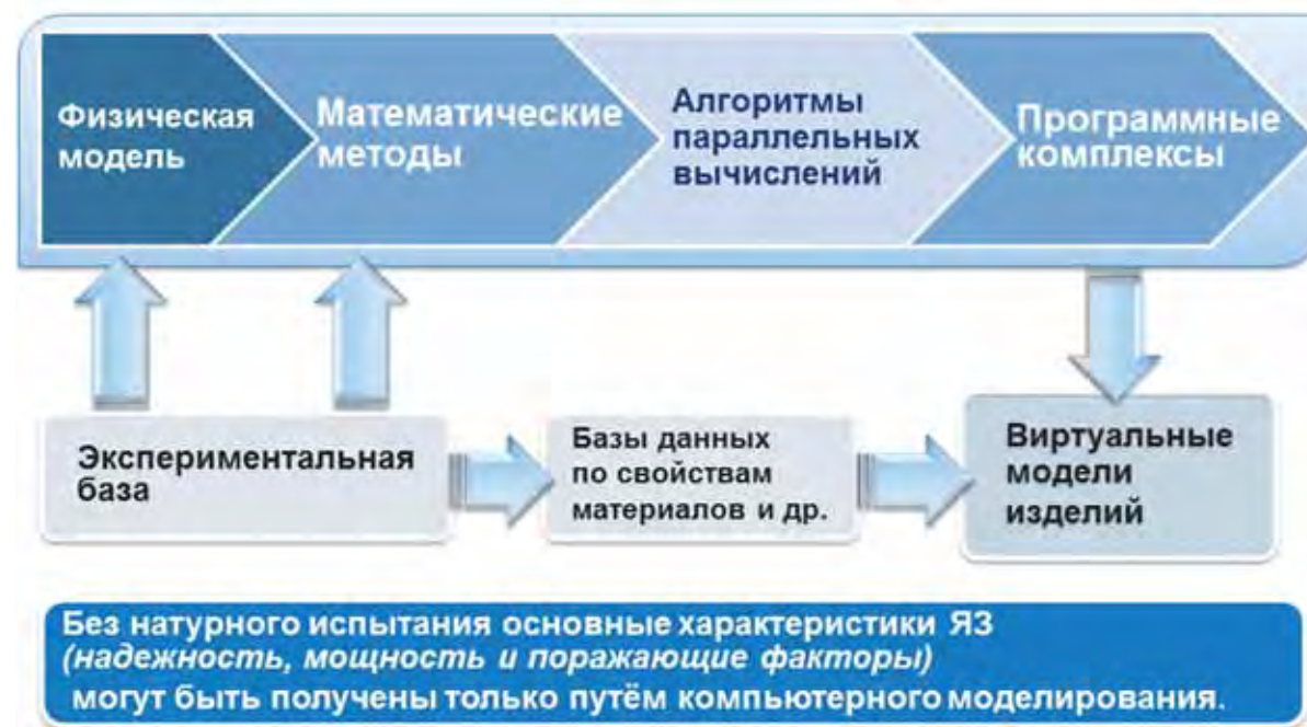
Рисунок 1. Комплексная замкнутая технология имитационного моделирования в интересах проектирования и разработки сложных изделий, обоснования их надежности без полномасштабных испытаний
