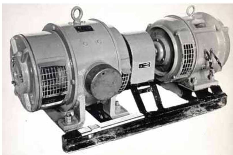
Агрегат питания МНГ-5 радиолокационных станций
