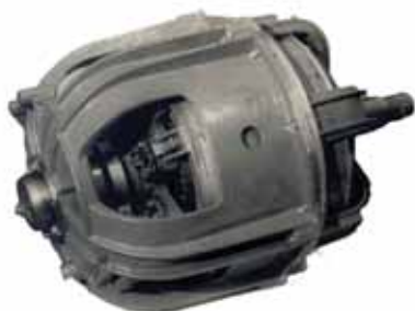
Биротативный гребной торпедный электродвигатель
