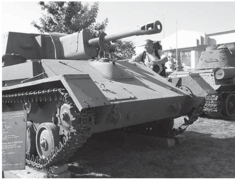
Одна из 4270 самоходных артиллерийских установок САУ-76, бронекорпуса для которой производились на заводе в 1943-44 годах
