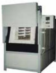
**Электропечь для промышленной термообработки металлов**
