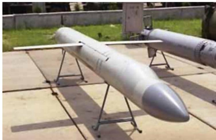
**Противокорабельная крылатая ракета ЗМ-543 экспортного комплекса CLUB. Титан используется в несущих элементах конструкции крыла и корпуса ракеты**
