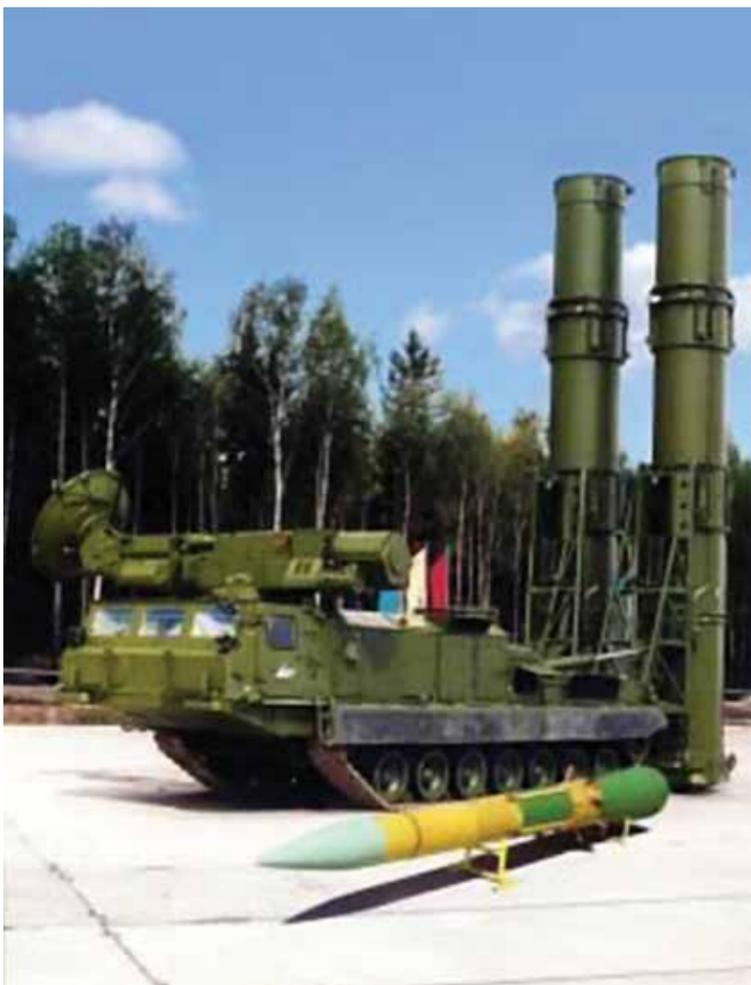
**Самоходная пусковая установка 9А82 с ракетой 9М82 из состава зенитно-ракетной системы С300В. Днища двигателей и аэродинамические рули ракеты — из верхнесалдинского титана**
