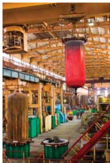
**Участок вакуумной сепарации. Раскалённая реторта из вакуумной печи, где при температуре 990-10200С происходит очистка губчатого титана от ненужных примесей, уезжает в холодильник. Березники**
