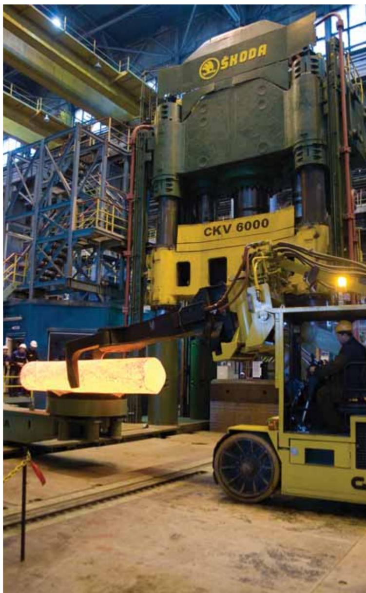
Ковочный пресс фирмы SKODA усилием 6.000 тонн
