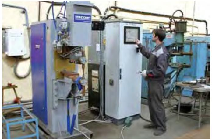
Оборудование для контактной сварки с системой управления качеством сварочных процессов, цех 20
