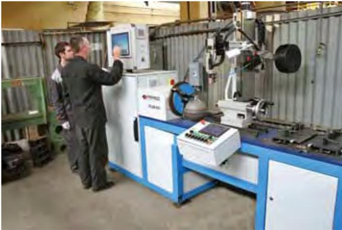
Оборудование для автоматической сварки кольцевых швов шаровых баллонов, цех 20
