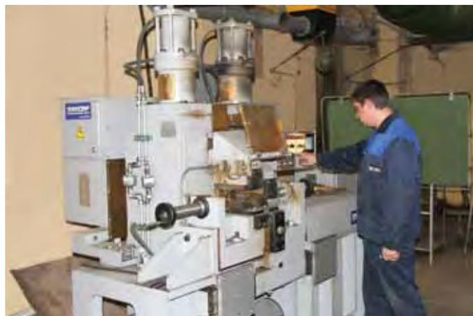
Машина для контактно-стыковой сварки оплавлением, цех 61
