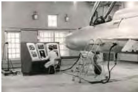
Полуавтоматический стенд для отработки радиолокационной станции в комплексно-испытательной лаборатории
