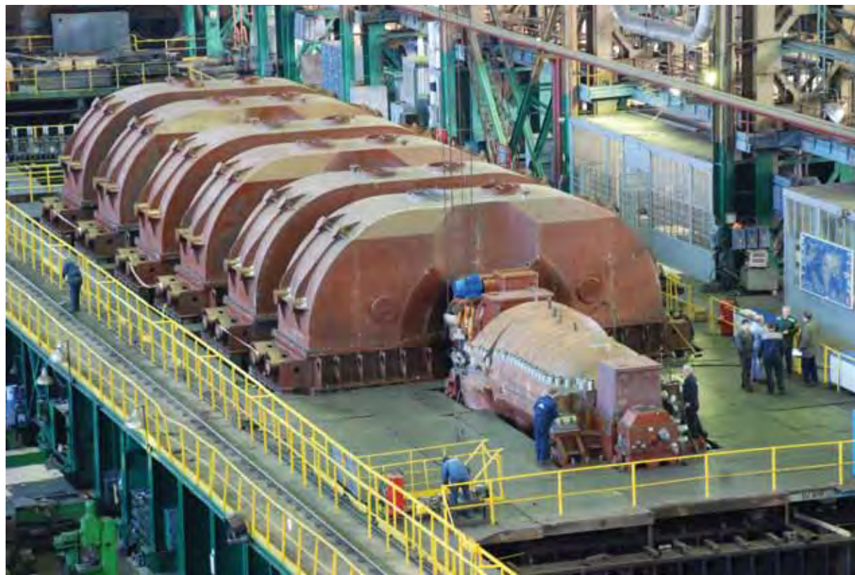
Белоярская турбина К-800 на сборочно-испытательном стенде 201-го цеха ЛМЗ 31 марта 2011 года
