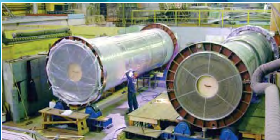
Изготовление Теплообменников УН-4 11СП для Белоярской АЭС на Балтийском заводе
