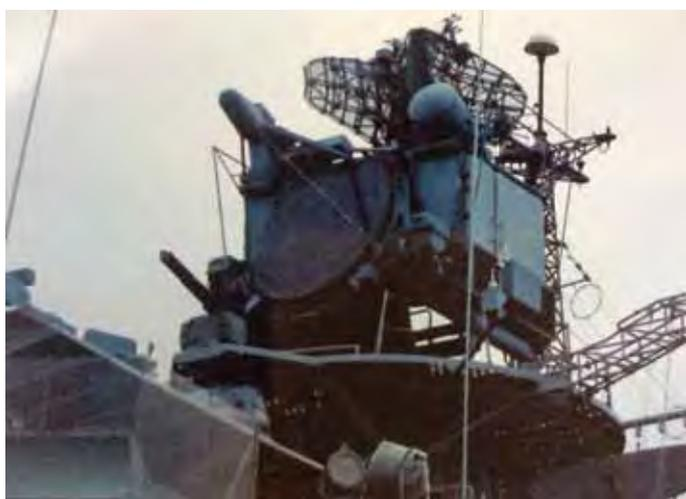
ЗРК «Кинжал», структурно построенный как ЗРК «Оса-М» и обладающий автономностью работы в отличие от других корабельных ЗРК, не имеющих своего канала обнаружения.
