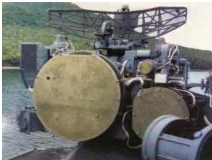
Антенный прибор системы управления ЗРК «Оса-М»
