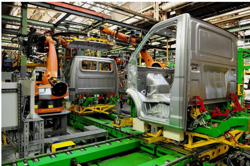
Роботизированная линия сварки кабин «ГАЗелей NEXT»
